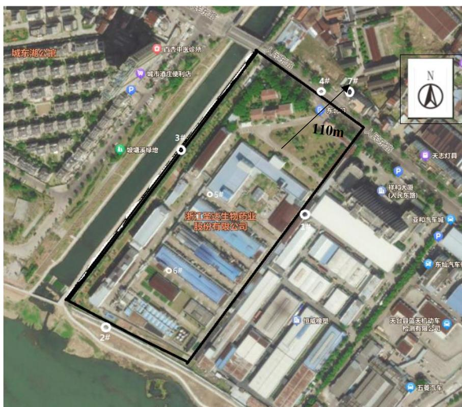
图7.4-1 无组织废气及环境空气采样点位示意图
